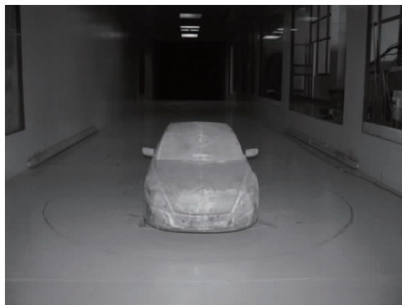
图 5 模型风洞试验图
